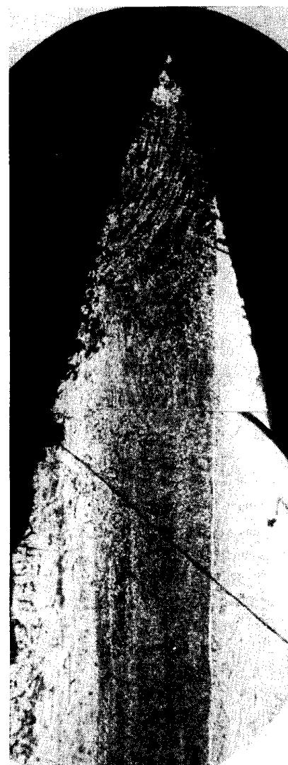
Рис. 37. Микроструктура острия многослойного лезвия ножа
