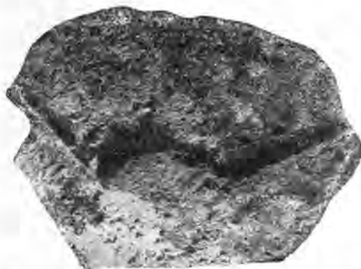
Рис. 8. Дно чугунного котла (в центре видна «лепешка», указывающая на место подвода металла, и литейные швы)
