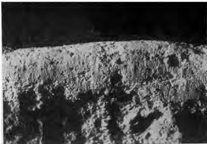
Рис. 2. Микрофотография рабочего лезвия керамического скребка
