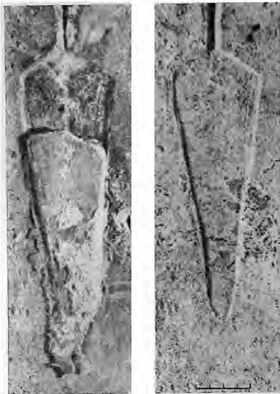
Рис. 3. Створки литейной формы, использованной в лабораторных экспериментах, с бракованной отливкой внутри
