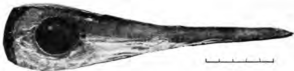
Рис. 5. Топор, ан. 1240. Макроструктура вертикального среза переднего торца
